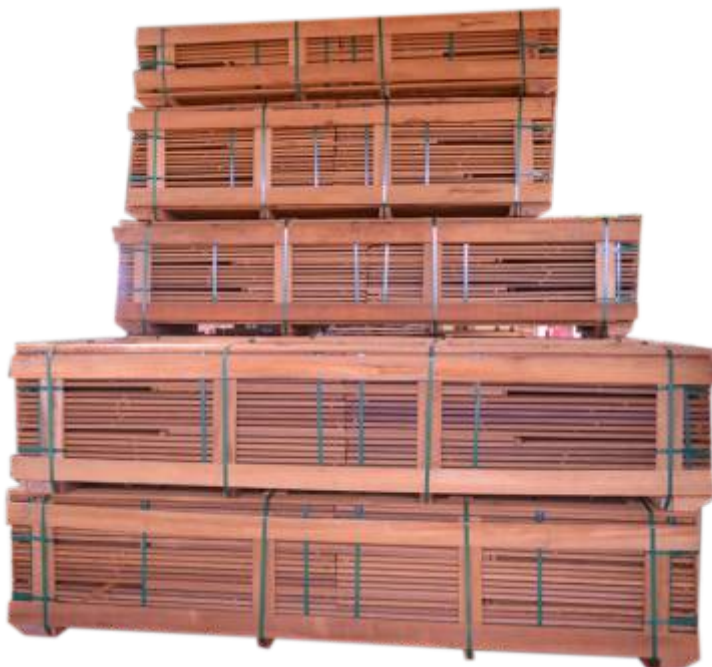
FOTO 07: Madeira beneficiada em pacotes, pronta para a expedição cuja embalagem não permite a visualização para aferição volumétrica
